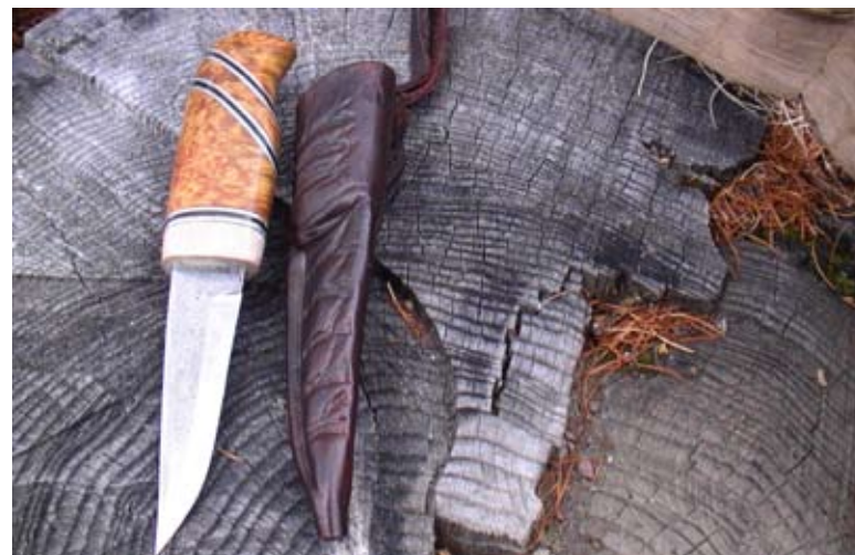
HANDSMITT BLAD I KOLSTÅL, SKAFT AV SÄLGRÖT, ÄLGHORN SAMT MELLANLÄGG AV TENN OCH SVART VULCANPAPP.
