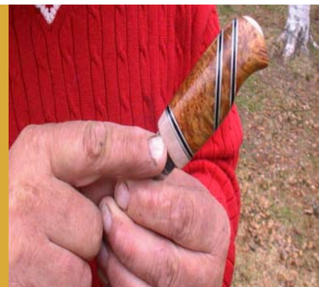
HANDSMITT BLAD I KOLSTÅL, SKAFT AV SÄLGRÖT, ÄLGHORN SAMT MELLANLÄGG AV TENN OCH SVART VULCANPAPP.
