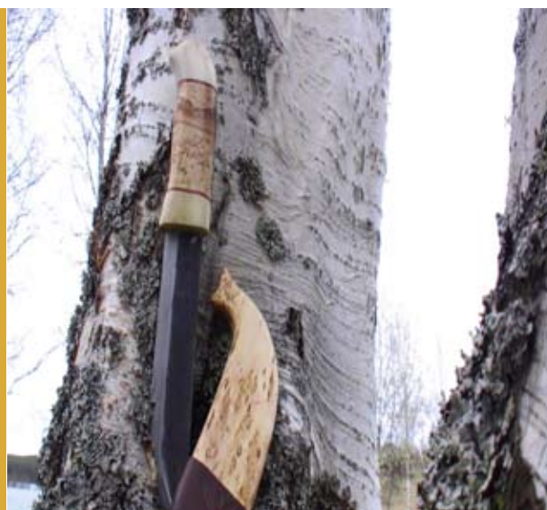
HANDSMITT BLAD I KOLSTÅL, SKAFT AV BJÖRKMASUR OCH ÄLGHORN. MELLANLÄGG AV TENN OCH RÖD VULCANPAPP.
